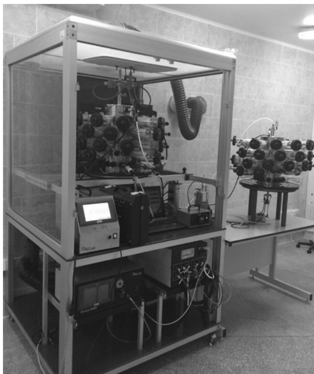
Рис. 2. Общий вид экспериментальной установки (сфотографировано со снятыми дверцами вытяжной кабины). Вне кабины видна аналогичная установка для псевдо-экспозиции контрольных крыс.
