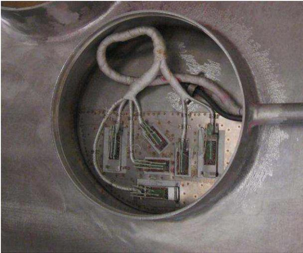
Рис. 2. Тензотермосборка СВТ
