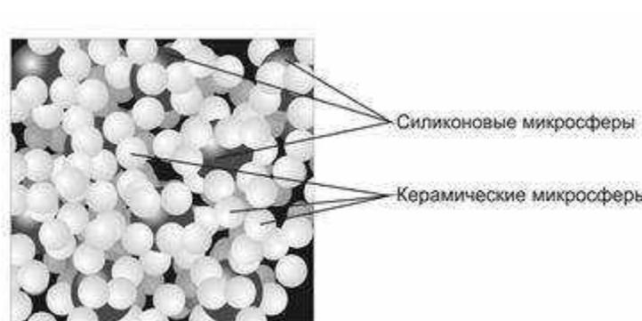
Рис. 5. Структурное строение ЖКТ RE-THERM
