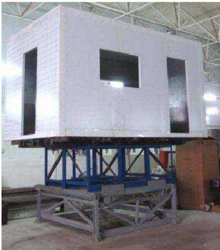
Рис. 4. Установка кузова вахтового автобуса на стенд – опрокидыватель
