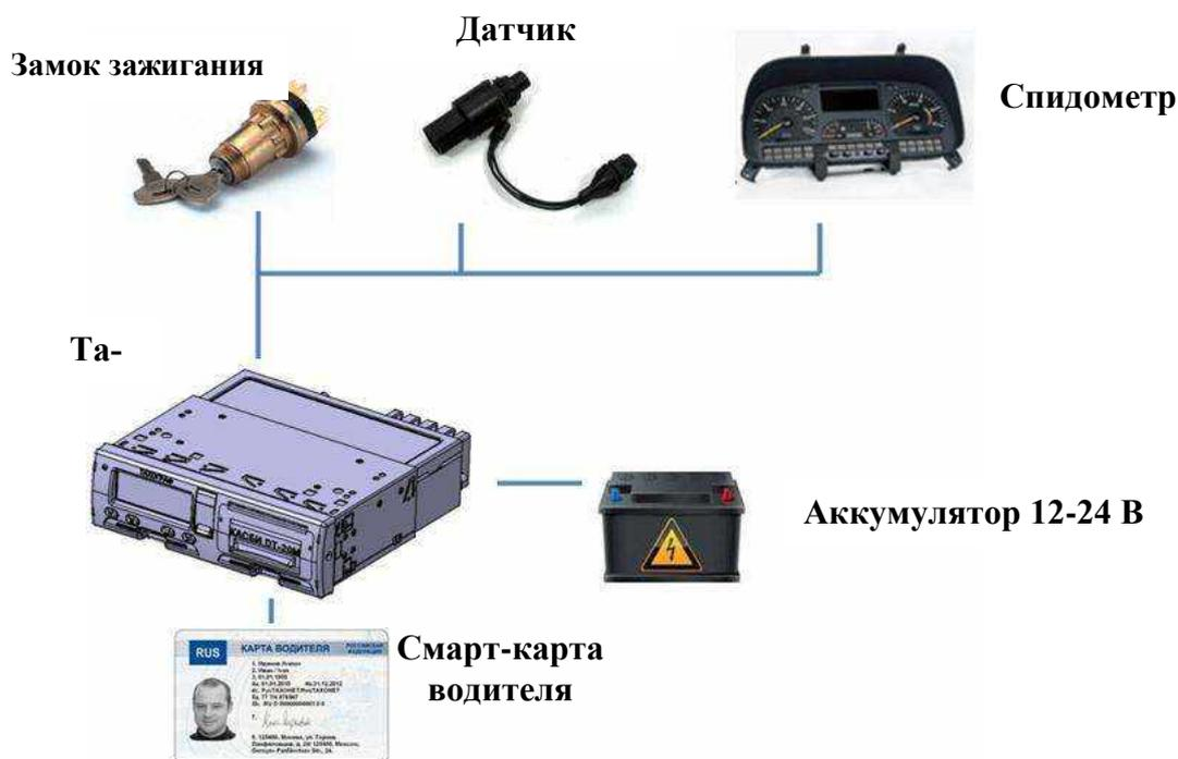
Рис. 3. Принцип работы тахографа
