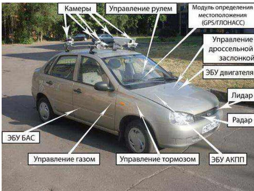
Рис. 3. Макетный образец беспилотного автомобиля на базе автомобиля «Лада-Калина» [2]
