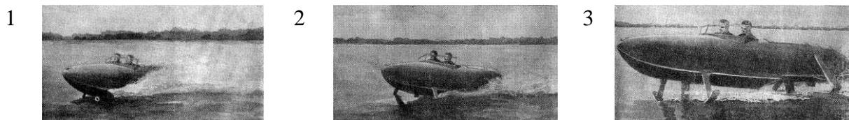
Рис. 2. Кинограмма испытаний самоходной модели СПК. Разгон и выход на крылья
