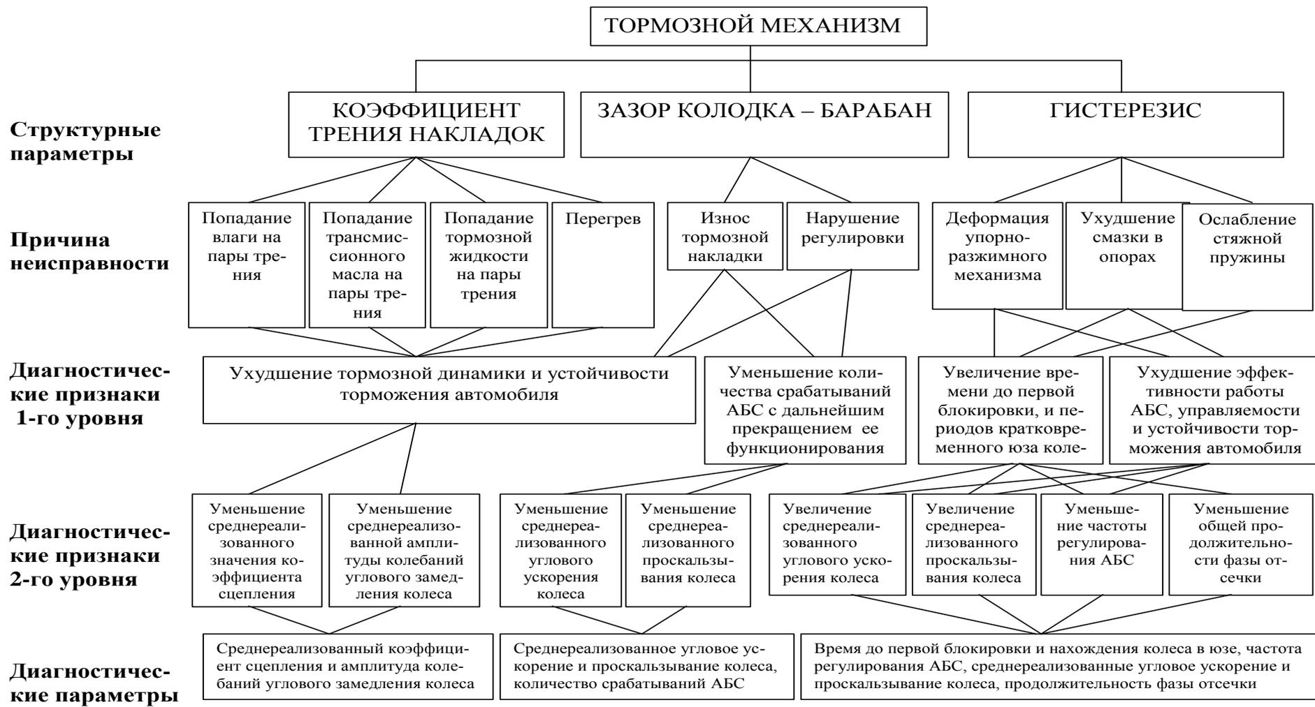
Рис. 5. Структурно-следственная схема для диагностирования тормозного механизма автомобиля с пневматической тормозной системой, оснащенной АБС
