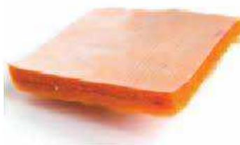
Рис. 4. Образец вибропоглощающего материала ВТП-2В
