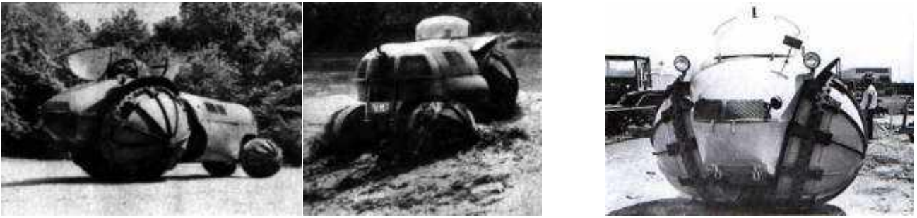
Полусферические полые колеса изобретателя Elie P. Aghnides
