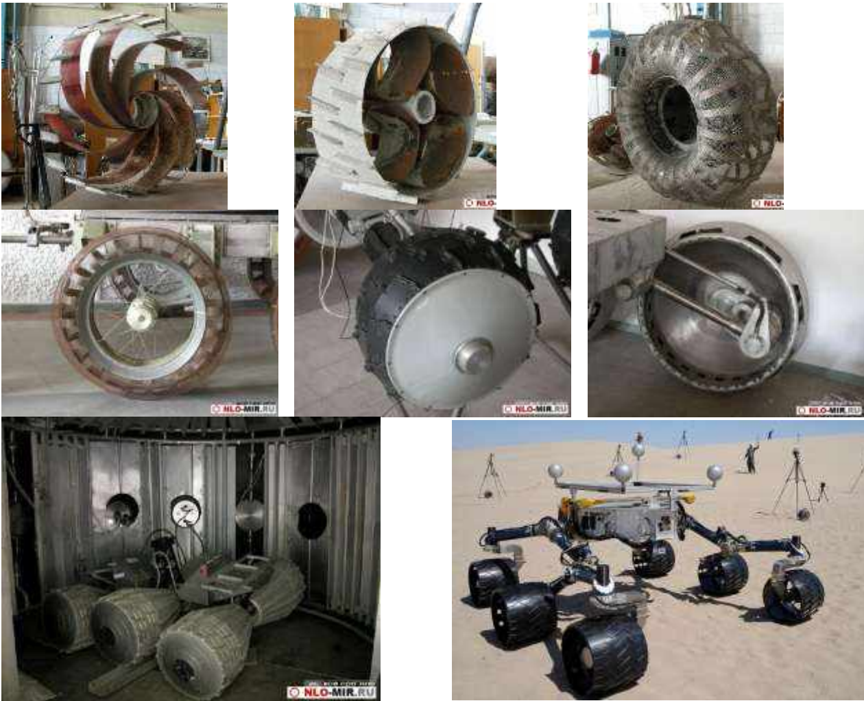
Металлоупругие колеса планетоходов
