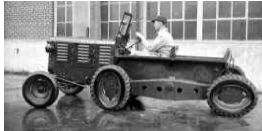
Трактор М7 с эллипсоидными колёсами (испытания 1946 год). [Фото из архива LIFE]
