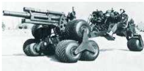
Планетарно-колесный движитель: самоходная гаубица М101 и машина «Terrastar» фирмы Lockheed Ground Vehicle Systems
