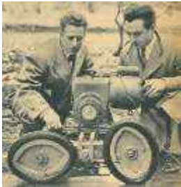
Трактор М7 с эллипсоидными колёсами (испытания 1946 год). [Фото из архива LIFE]
