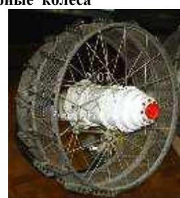
Металлоупругое колесо Лунногохода
